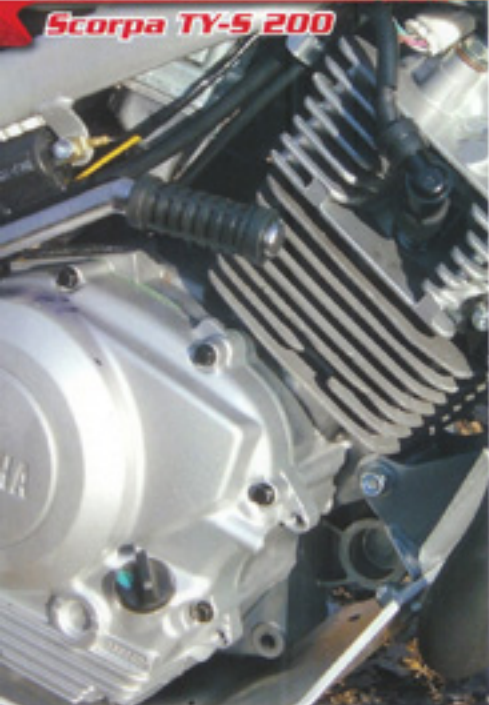
Effort de Christian Rayer pour le développement de ce kit, qui permet de passer de 125 à 200 cm 3 sans tout ouvrir.
